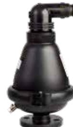
Série 701/75 Ventouse triple fonction DN 50-200 PN 10 Polyamide armée
