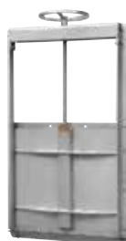
Série 772/61 Vanne murale Bi-directionnelle jusqu'à 1200 X 1200 mm Autres dimensions uni ou bi-directionnelle Tige non montante Acier inoxydable AISI 304 200 x 200 mm à 2000 x 2000 mm
