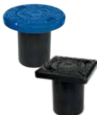
Série 04/007 Bouche à clé flottante pour allonge télescopique Corps en matériau composite PE Tampon en fonte ductile
