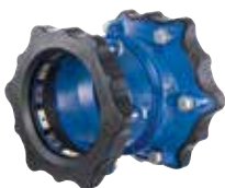
Série 631/00 Manchon symétrique large tolérance autobuté Supa Maxi™ Multimatériaux DN 50-600 PN 16 Fonte ductile
