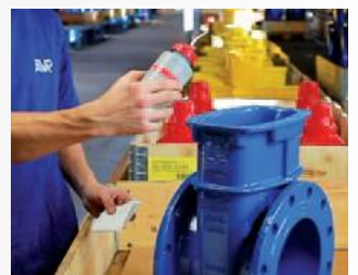
Beim MIB Test darf es keine Farbverwischung geben
