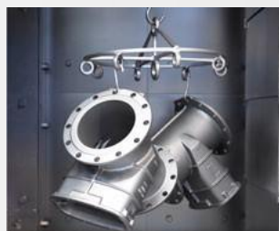
AVK Schieber werden nach ISO 12944-4 gestrahlt
