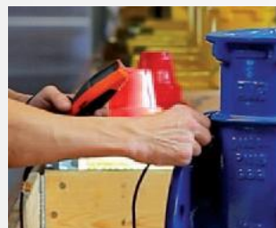
Die Epoxidschichtdicke muss mind. 250 µ auf allen Oberflächen sein
