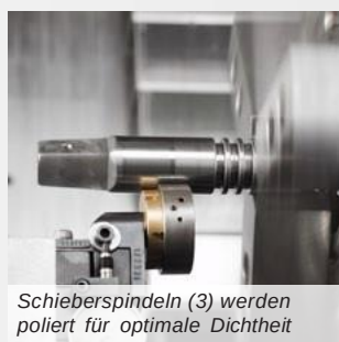
Die automatisierte Spindelfertigung sichert einheitliche Güte
