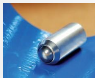
Die Schlagfestigkeit wird mit einem Stahlzylinder geprüft
