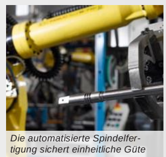
Schieberspindeln (3) werden poliert für optimale Dichtheit
