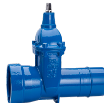
Serie 33/50 Saracinesca con estremità a bicchiere BLS®/ad innesto BLS® per tubi in ghisa DN80-300 PN16 Ghisa sferoidale
